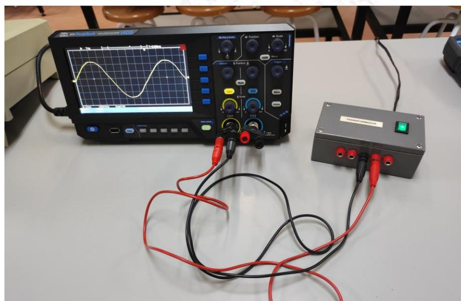
Figura 5. Medida de la amplitud y el período de una señal  $V(t)$
