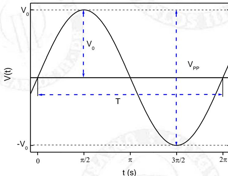
$V_{PP}$  es el voltaje pico a pico:  $V_0 = \frac{V_{PP}}{2}$ , y  $T$  es el período de la señal
