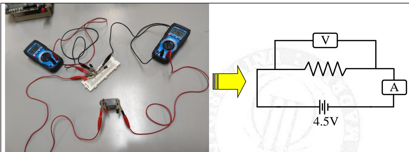
Figura 4. Medida de la corriente y la caída de voltaje a través de una resistencia
